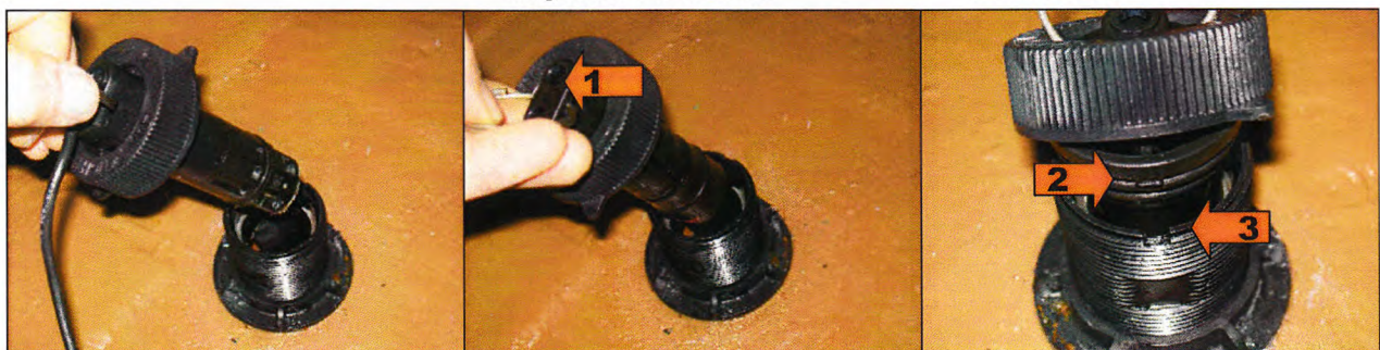
51. Logsensor gezogen, es tritt Wasser ein
