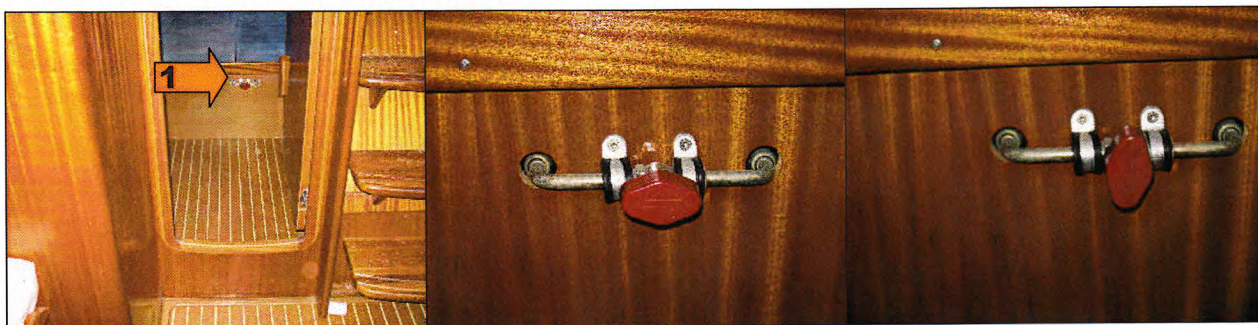
29. Wartungs- und Problemstellung: Dieselhauptahn geschlossen
